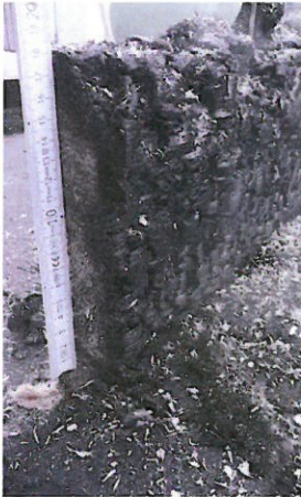
Bild A6.9 Restquerschnitt Ständer 1.
