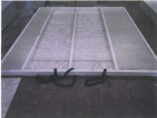
Bild A5.1 Blick auf die Wandkonstruktion von der Rähmseite, Horizontalstoß- Hinterlegung mit Streifen aus OSB- Platten.
