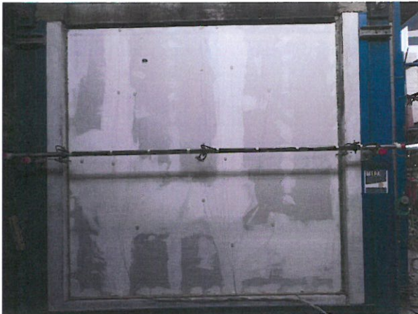
Bild A6.1 Wandkonstruktion im eingebauten Zustand vor Beginn der Feuerwiderstandsprüfung.
