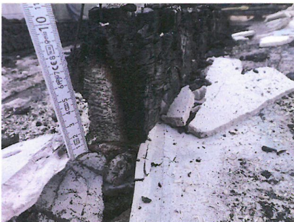
Bild A6.9 Restquerschnitt Ständer 2.
