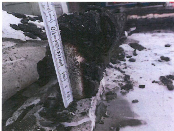
Bild A6.10 Restquerschnitt Ständer 3.
