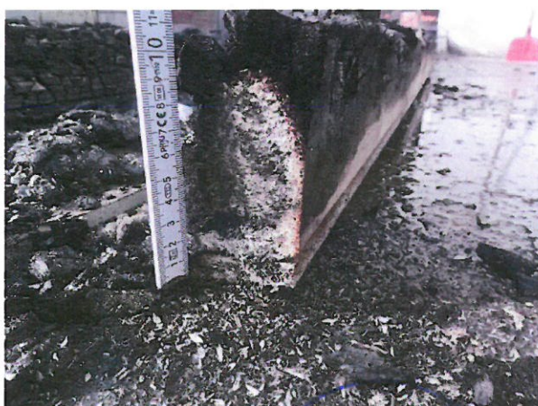
Bild A6.12 Restquerschnitt Ständer 5.
