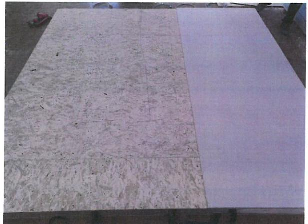
Bild A5.2 Blick von der Rähmseite, Beplankung mit Feuerschutzplatten auf der Lage aus OSB/4- Platten.
