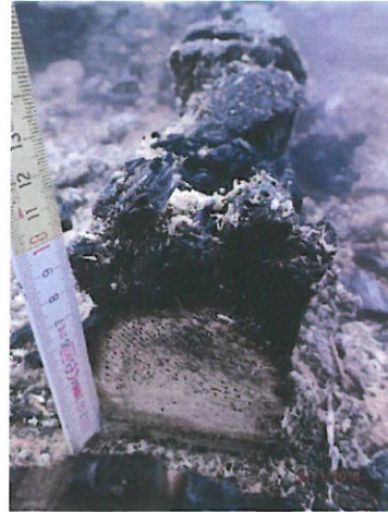
Bild A6.8 Restquerschnitt Ständer 2.
