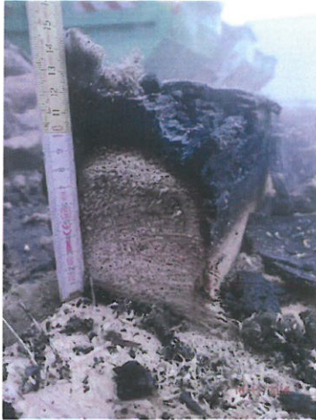
Bild A6.7 Restquerschnitt Ständer 1.
