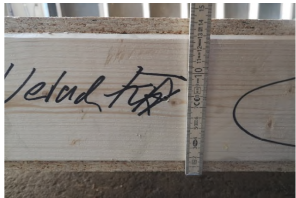
Bild 4 Ansicht auf den Querschnitt des fertiggestellten Probekörpers vor dem Einbau in den Prüföfen.
