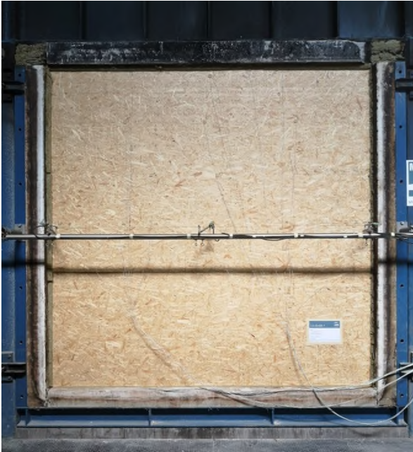
Bild 5: Wandkonstruktion vor Beginn der Feuerwiderstandsprüfung.
