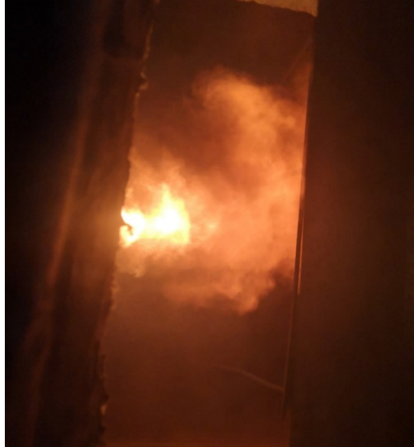
Bild 6: Prüfminute 1 – Schwarzfärbung der Oberfläche der Beplankungs-/Bekleidungs-lage.
