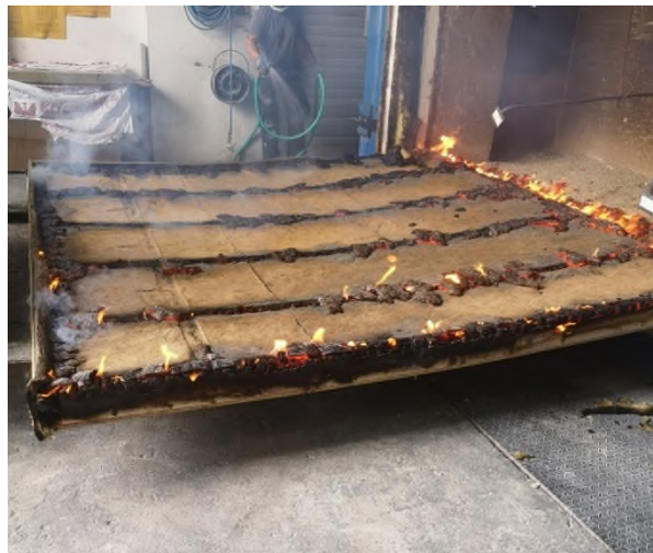
Bild 10: Ende der Feuerwiderstandsprüfung nach Trag- fähigkeitsversagen.
