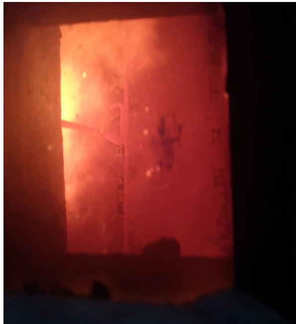
Bild 10: Prüfminute 45 – Beplankungs-/ Bekleidungs- lage vollständig vom Ständerwerk abgefallen. Gefachdämmstoff vollständig freigelegt.
