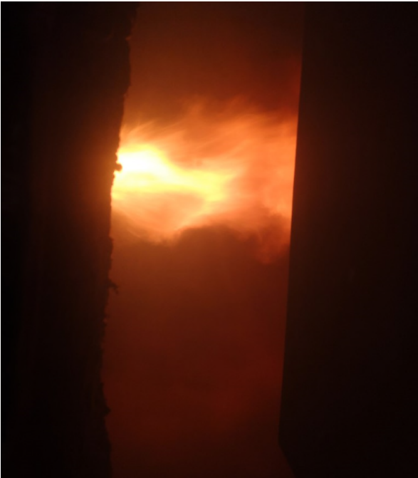
Bild 7: Prüfminute 7 – Eigenbrand des Probekörpers. Sichtprüfung nur noch eingeschränkt möglich.
