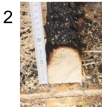
Bild 13 Restquerschnitt am zweiten Ständer (ca. 85 mm)
