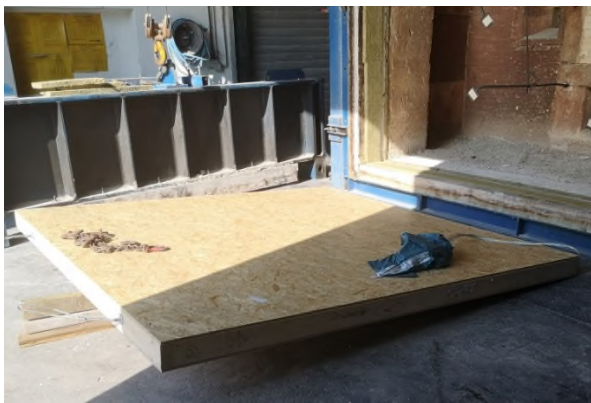
Bild 3 Ansicht auf die Bekleidungs-/Bepunktungslage der feuerzugewandten Wandseite.
