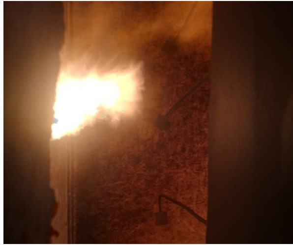
Bild 6: Prüfminute 1 – Schwarzfärbung der Oberfläche der Beplankungs-/Bekleidungsfläche.
