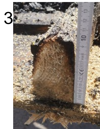
Bild 14 Restquerschnitt am dritten Ständer (ca. 100 mm)
