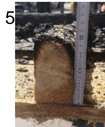
Bild 16 Restquerschnitt am fünften Ständer (ca. 100 mm)
