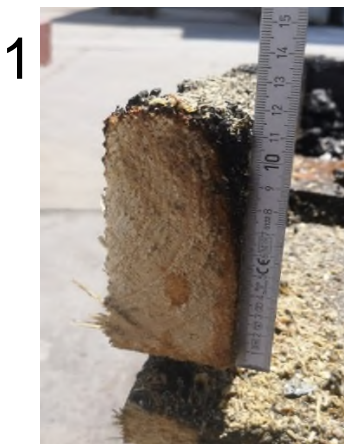
Bild 12 Restquerschnitt am ersten Ständer (ca. 120 mm)
