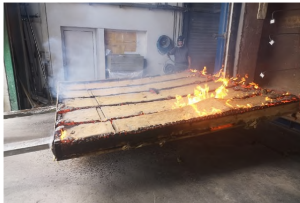
Bild 10: Ende der Feuerwiderstandsprüfung nach Tragfähigkeitsversagen.
