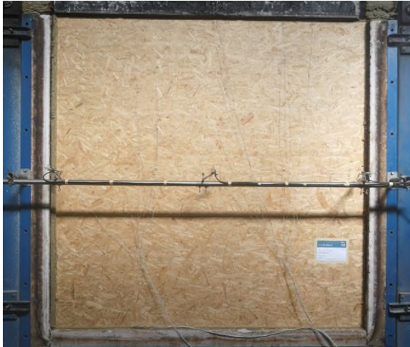
Bild 5: Wandkonstruktion vor Beginn der Feuerwiderstandsprüfung.
