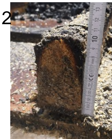
Bild 13 Restquerschnitt am zweiten Ständer (ca. 95 mm)
