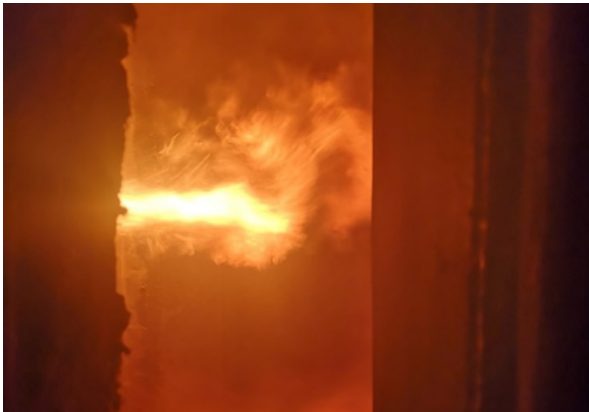
Bild 7: Prüfminute 3 – Eigenbrand des Probekörpers. Sichtprüfung nur noch eingeschränkt möglich.
