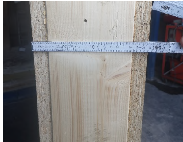
Bild 4 Ansicht auf den Querschnitt des fertiggestellten Probekörpers vor dem Einbau in den Prüföfen.
