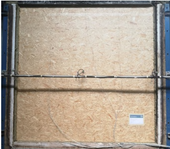
Bild 5: Wandkonstruktion vor Beginn der Feuerwiderstandsprüfung.
