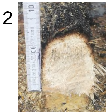
Bild 12 Restquerschnitt am zweiten Ständer (ca. 75 mm)
