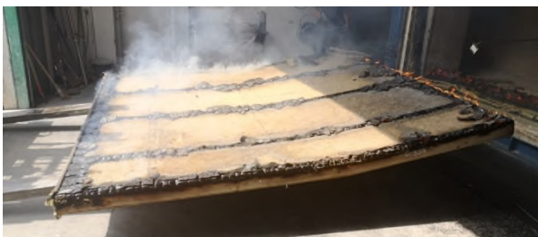
Bild 9: Ende der Feuerwiderstandsprüfung nach Tragfähigkeitsversagen.
