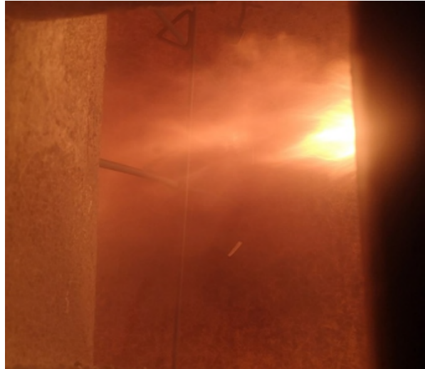
Bild 6: Prüfminute 1 – Schwarzfärbung der Oberfläche der Beplankungs-/Bekleidungsfläche.
