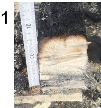
Bild 11 Restquerschnitt am ersten Ständer (ca. 85 mm)
