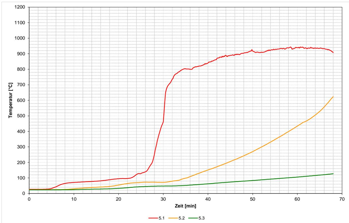
Diagramm 18 Temperaturentwicklung der Messstellen am Ständerwerk (Position 6.X)
