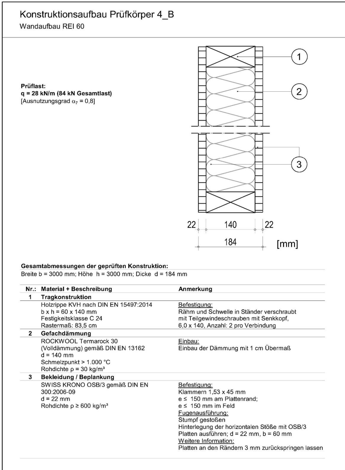
Abbildung 2 Gesamtdarstellung des Probekörpers mit Verlegeanordnung der Beplankungs-/Bekleidungs-lage.
