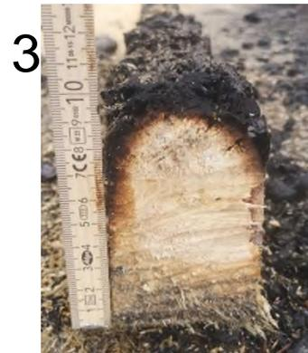
*Bild 16 Restquerschnitt am dritten Ständer (ca. 90 mm)*
