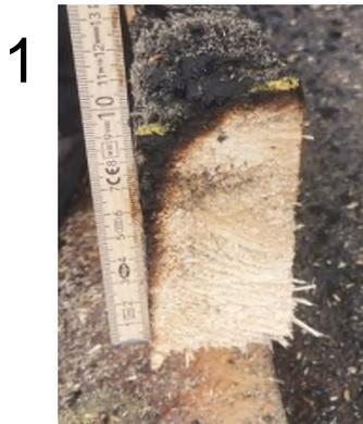
*Bild 14 Restquerschnitt am ersten Ständer (ca. 105 mm)*
