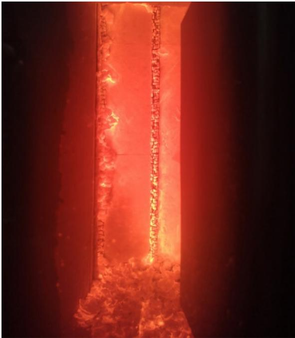
*Bild 10: Prüfminute 40 – Bepunktungs-/ Bekleidungs- lage vom Ständerwerk abgefallen. Gefachdämmstoff vollständig freigelegt.*
