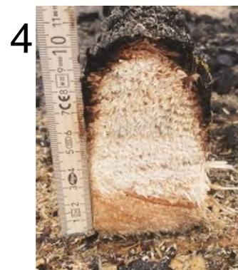
*Bild 17 Restquerschnitt am vierten Ständer (ca. 95 mm)*
