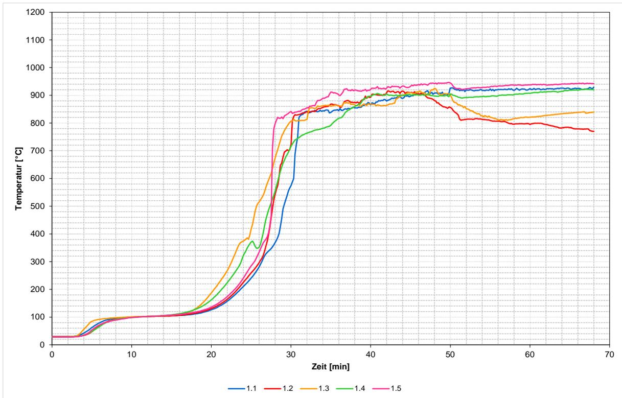
Diagramm 13 Temperaturentwicklung an Messstellen der feuerabgewandten Beplankungsinenseite.
