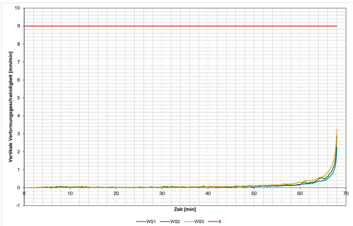
Diagramm 9 Belastung der Wandkonstruktion während der Feuerwiderstandsprüfung
