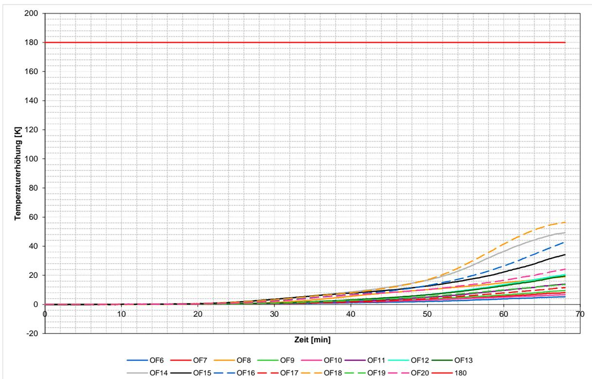
Diagramm 12 Temperaturentwicklung an Messstellen der feuerzugewandten Beplankungsinenseite.
