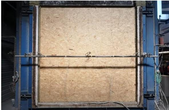
*Bild 6: Wandkonstruktion vor Beginn der Feuerwiderstandsprüfung.*
