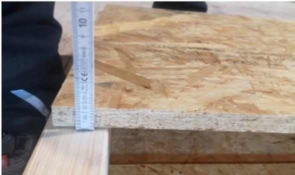
**Bild 3** Detailansicht auf die vorbereitete Bekleidungs-/Beplankungslage der feuerzugewandten Wandseite.
