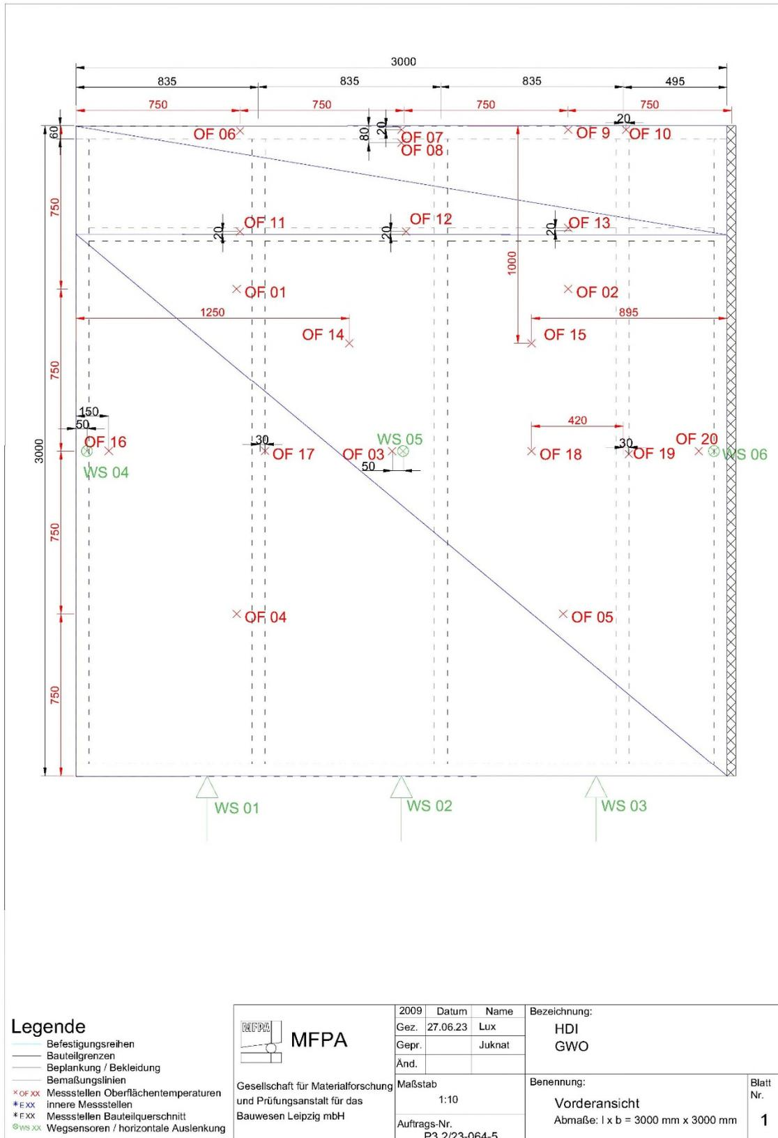
Abbildung 4 Anordnung der Messstellen innerhalb des Probekörpers (feuerabgewandt)
