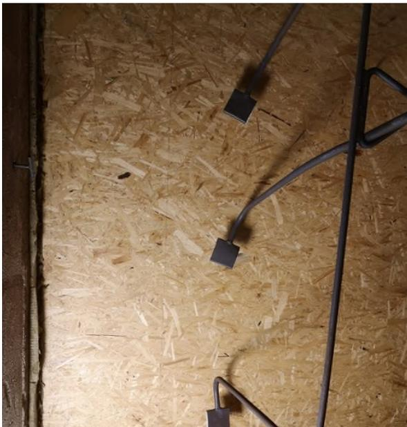
**Bild 5** Ansicht auf die vollständig montierte feuerzugewandte Beplankungs-/Bekleidungs-lage.
